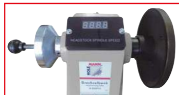
D 460FXL mit digitaler Drehzahlanzeige D 460FXL with DRO
