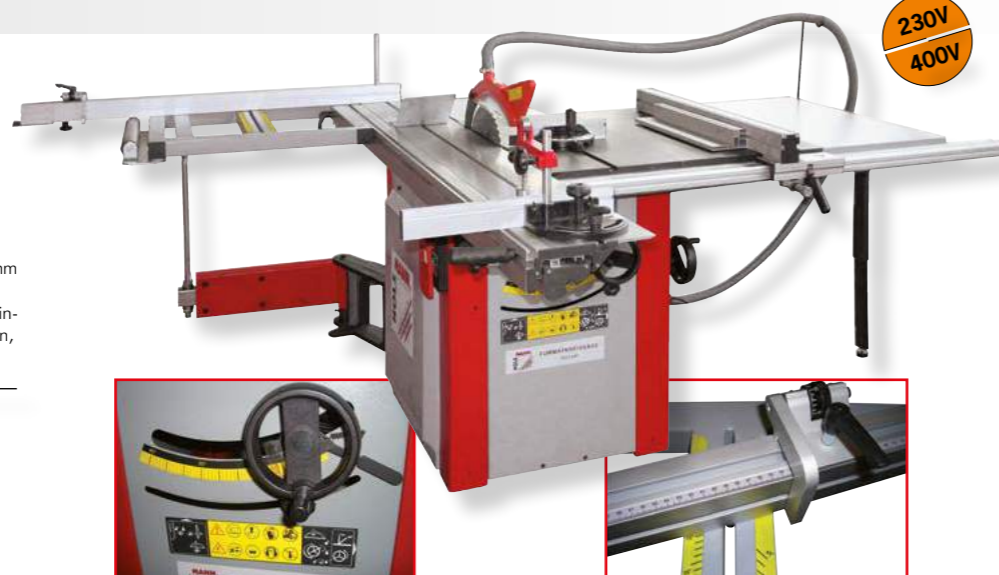
Sägeblatthöhenverstellung saw blade height adjustment
