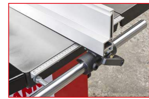
extra großer Parallelanschlag mit solider Führungsstange sorgt für eine präzise und reibungslose Handhabung extra large rip-fence with solid guide rod ensures precision, smooth sliding and splendid handling
