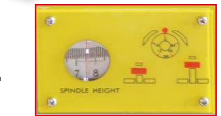
präzise Spindel Höhenanzeige precise spindle height indication
